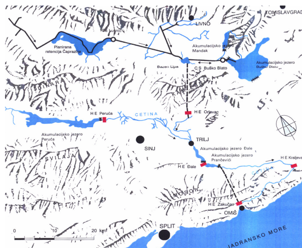
Slika 3. 34. Višenamjenski sustav na slivu Cetine
