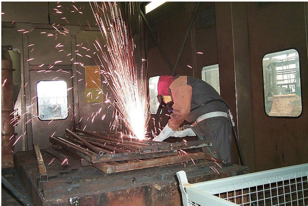
Slika 5-4: Toplinsko rezanje (izvor: EWN)
