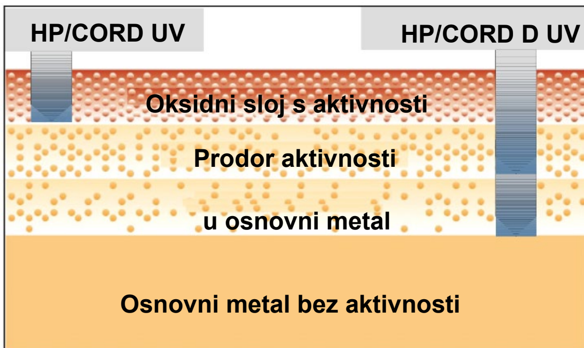
Slika 5-7: Načela procesa HP/CORD UV – HP/CORD D UV
