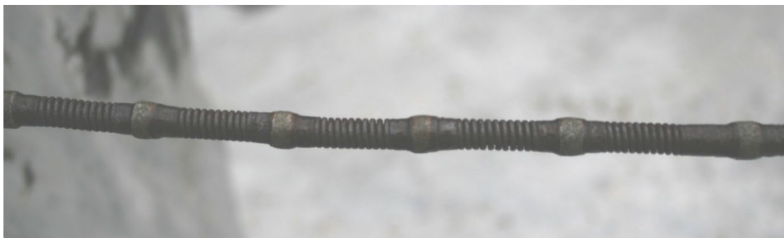
Slika 5-2: Žica za rezanje s dijamantnim reznim elementima i oprugama za razmak (izvor: Wikipedija)
