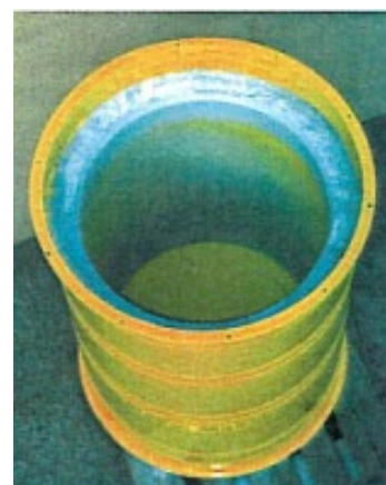
Slika 7-22: Bačva od 200 l sa zaštitom
